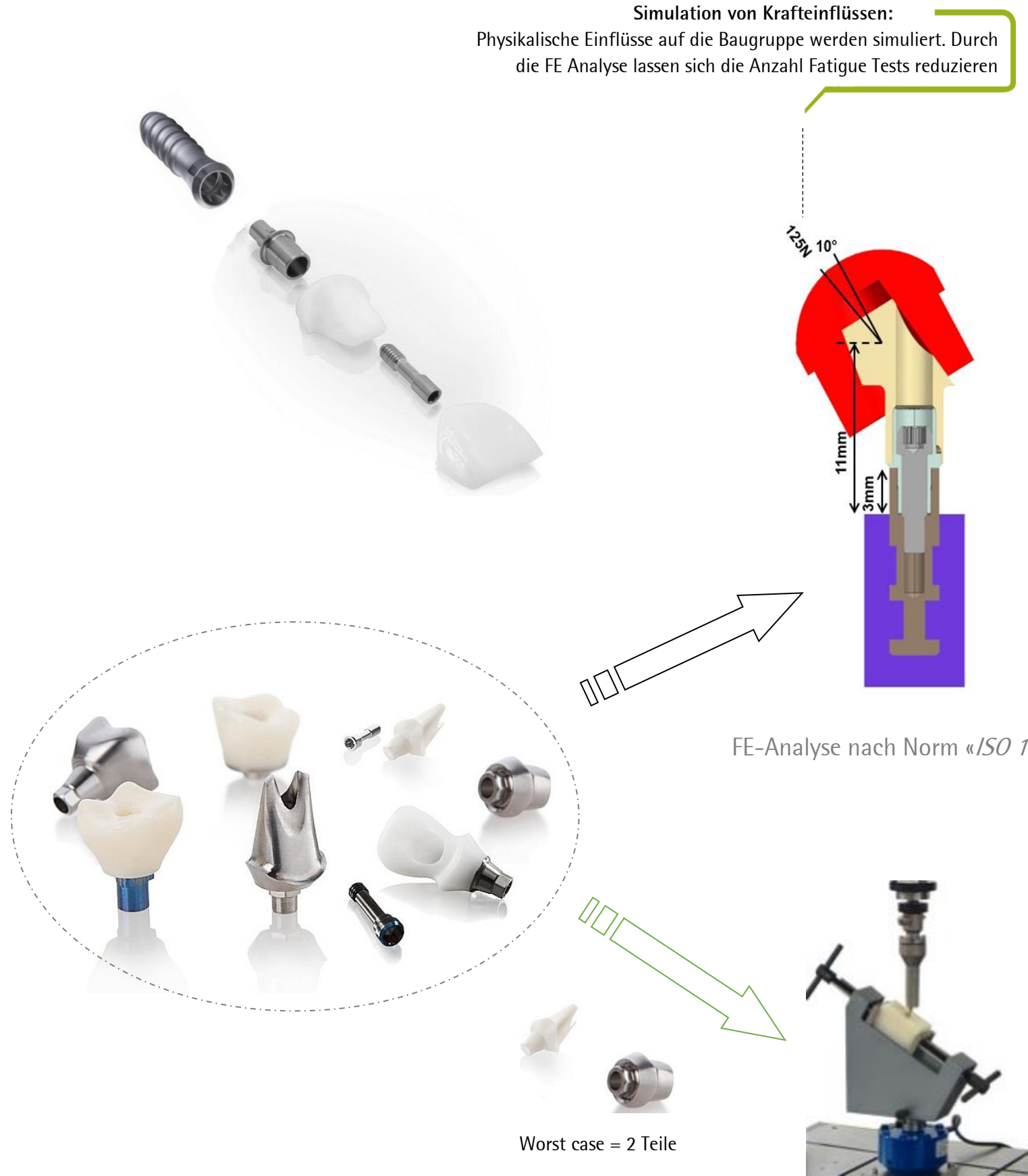
Fatigue Test nach Norm «ISO 14801»
