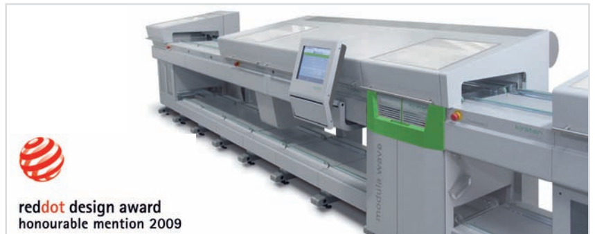
Neuartiges Lötconcept «Modula Wave». Entwickelt mit Pro/ENGINEER Wildfire Design: Meyer-Hayoz Design Engineering Group
